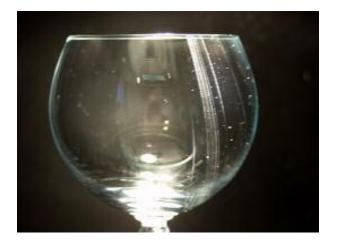
Figure 3: Linear corrosion Source: Glastechnische Tagung Leipzig 2003
